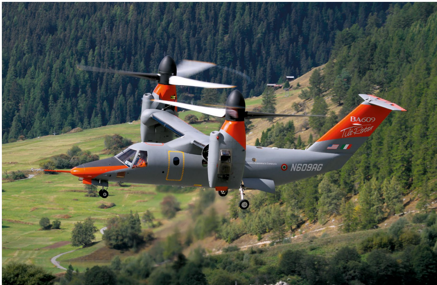
Der Tiltrotor Agusta-Bell BA609 führte 2009 Testflüge in Ulrichen durch. Inzwischen hat AgustaWestland das Programm als AWW609 ganz übernommen und treibt die Tiltrotor-Entwicklung vorwärts. Der 510 km/h schnelle AWW609 soll aber erst 2017 einsatzreif sein.
