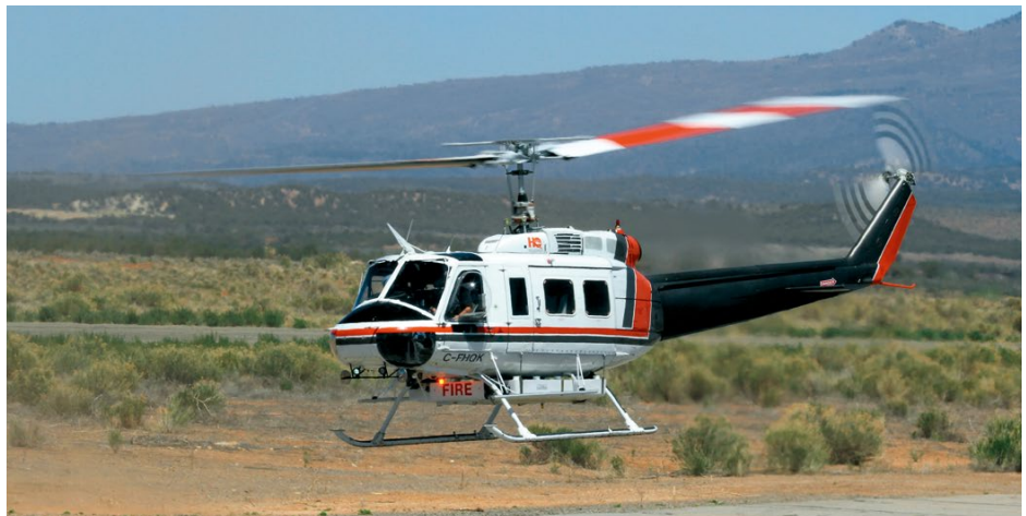
Der kanadische Bell 205A-1 C-FHQK von Heli Qwest gehört zur Helitanker-Flotte der Löschhelis. Unter dem Rumpf ist der 1200-Liter-Tank zu sehen, der mit einem Schnorchel aus dem Flug gefüllt wird.
