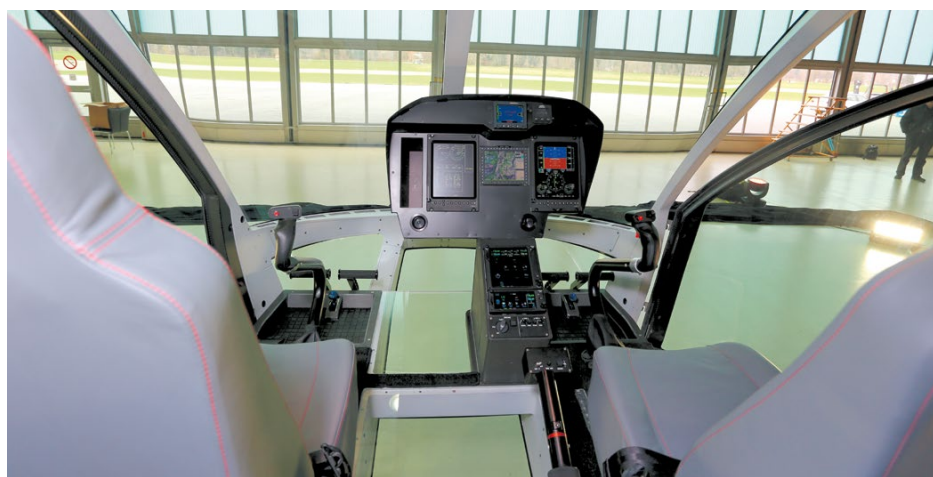
Das ICDS 8A Glascockpit des SKYe SH09 stammt von Sagem Avionics (Safran). Die Sicht aus dem Cockpit ist nicht nur wegen der verglasten Bodenplatte phänomenal.
