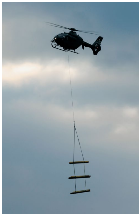
Unterschiedliche Anschlagtechniken: Links sind die Doka-Balken seriell am EC635 eingehängt, rechts parallel. Deutlich ist das unterschiedliche «Flugverhalten» zu sehen.
