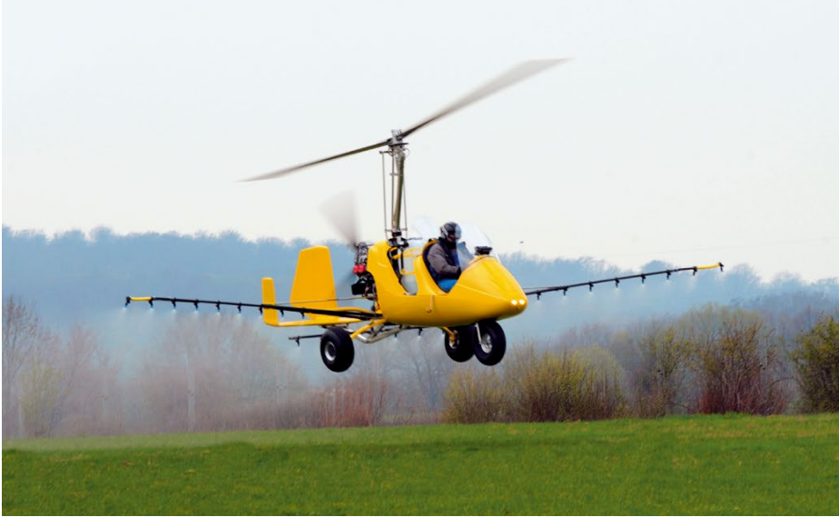
Auch das ist möglich: Ein Tragschrauber mit Rüstsatz für Sprüh-Flüge in der Landwirtschaft.
