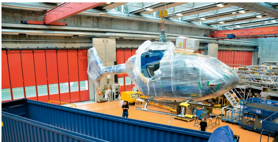
Der EC135P1, ex JA30TH, wurde im Frühling 2013 durch Helipool in Japan erworben und in die Schweiz importiert. RUAG Aviation in Alpnach machte den Heli nach dem Transport per Seefracht wieder flugtüchtig.
