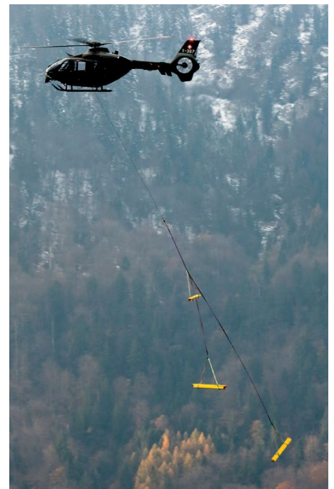
Unterschiedliche Anschlagtechniken: Links sind die Doka-Balken seriell am EC635 eingehängt, rechts parallel. Deutlich ist das unterschiedliche «Flugverhalten» zu sehen.
