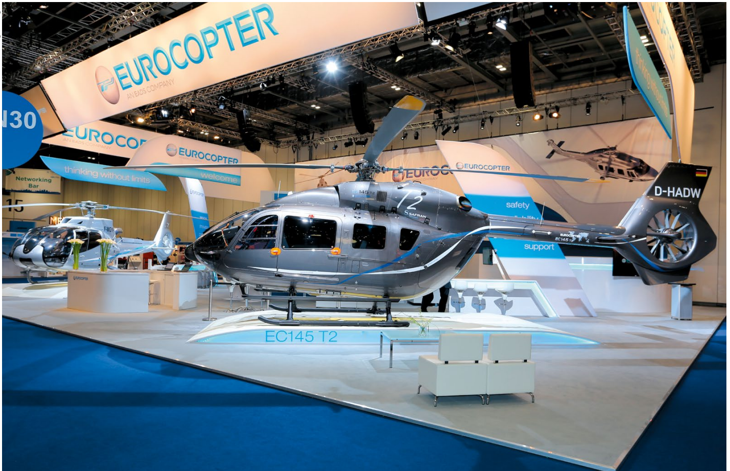
Eurocopter verschiebt die geplante Zertifizierung des EC145T2 auf den Frühling 2014. Die neue Version des EC145 hat unter anderem stärkere Triebwerke und einen Fenestron erhalten.
