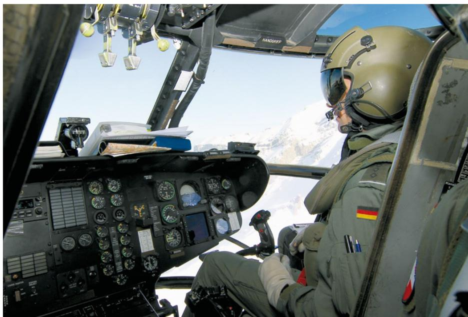
Analoge Instrumente dominieren das CH-53 Cockpit. Mit dem Umbau von 40 Maschinen zur Version CH-53GA halten auch Bildschirme Einzug.
