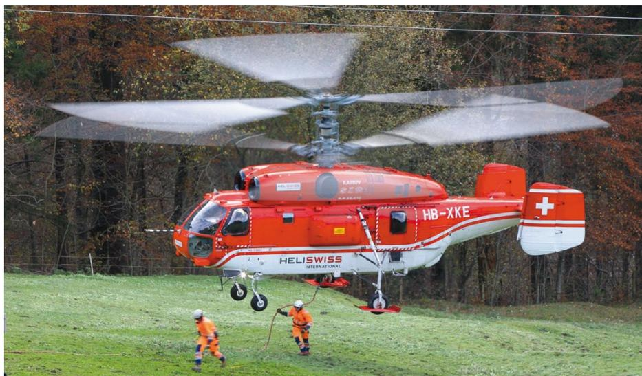
Grosse Helikopter wie der Kamov Ka-32 fallen unter die EASA-Definition der «Complex Aircraft». Werden solche Helis künftig für Arbeiten in Höhen über 3050 Metern eingesetzt, ist zusätzliche Sauerstoff-Versorgung für die Besatzung Pflicht.
