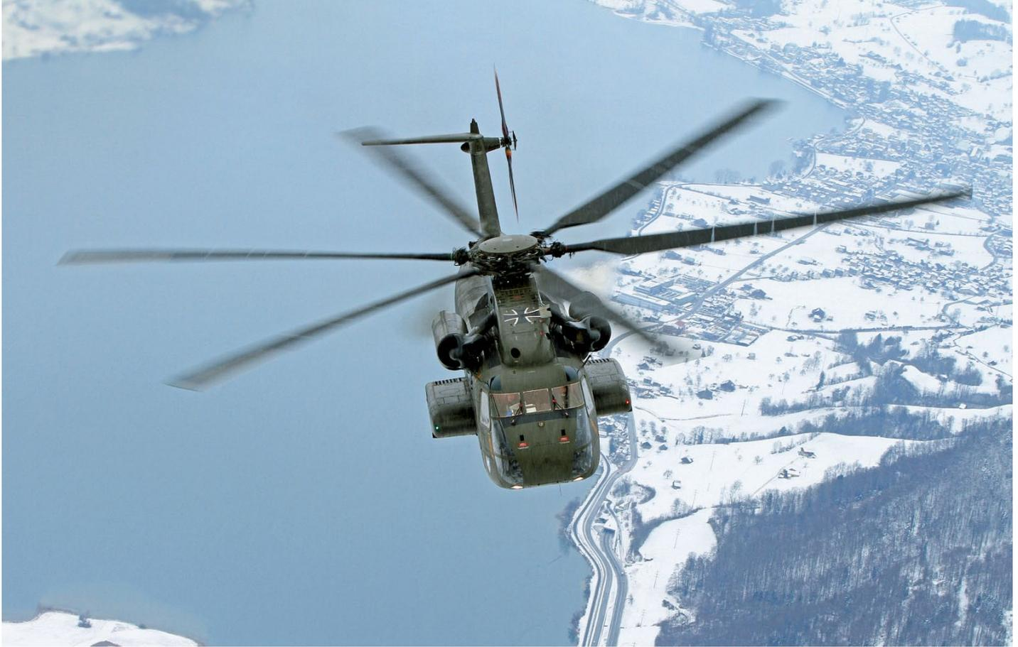
Der CH-53G über dem Sarnensee. Um eine realistische Beladung zu simulieren, sind Betonplatten mit zwei Tonnen Gewicht im Laderaum verzurrt.
