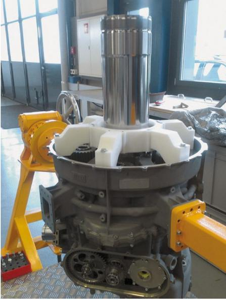
Wesentliche Teile des von Marenco entwickelten Getriebes für den SKYe SH09 wurden von Sauter Bachmann und Knoepfel hergestellt. Der Zusammenbau erfolgte bei RUAG in Alpnach.
