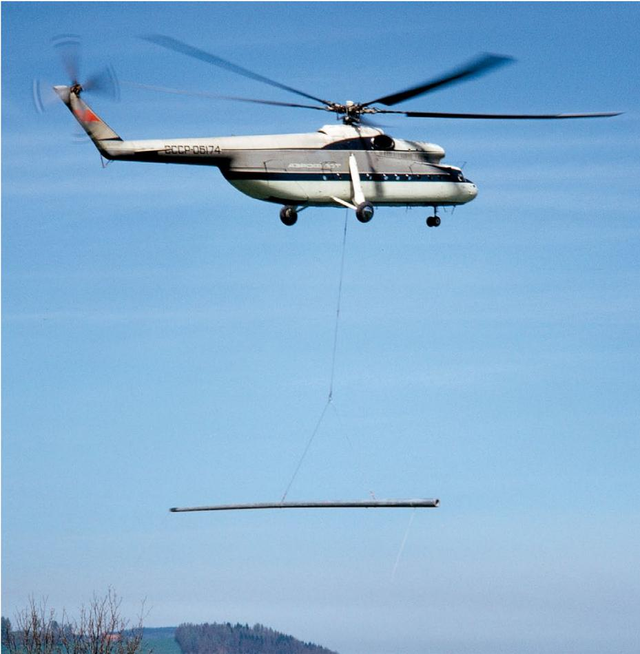
Die tonnenschweren Stahlbetonmasten transportierte der Mi-6 problemlos. Er konnte bis neun Tonnen schwere Aussenlasten befördern.
