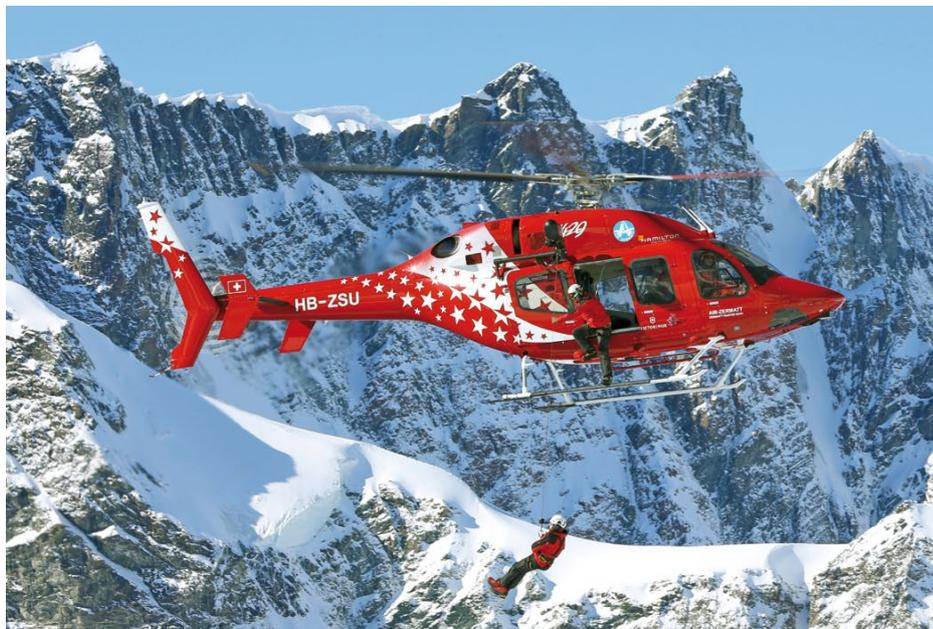
*Die Goodrich-Rettungswinde mit 90 Metern Seillänge und einer Tragkraft von 272 Kilogramm kann wahlweise vom Piloten oder vom Paramedic an der Kabinentür gesteuert werden.*
