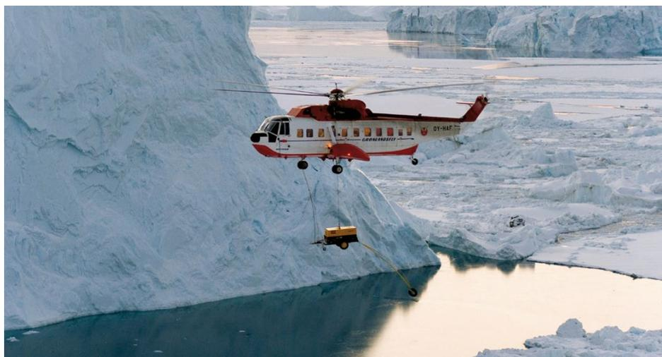
Seit 2008 kommen Sikorsky S-61 für die Mission in der Arktis zum Einsatz. Unter dem Heli hängt der Generator für den Projektor. Unter dem Generator ist ein Autopneu befestigt, der als «Frühwarnsystem» wirkt, sollte der Heli zu tief fliegen...
