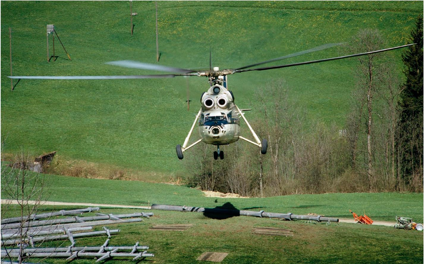
Mit seinen beiden Soloviev D-25V Turbinen verfügte der damals grösste Heli der Welt über eine Leistung von 11'000 PS.
