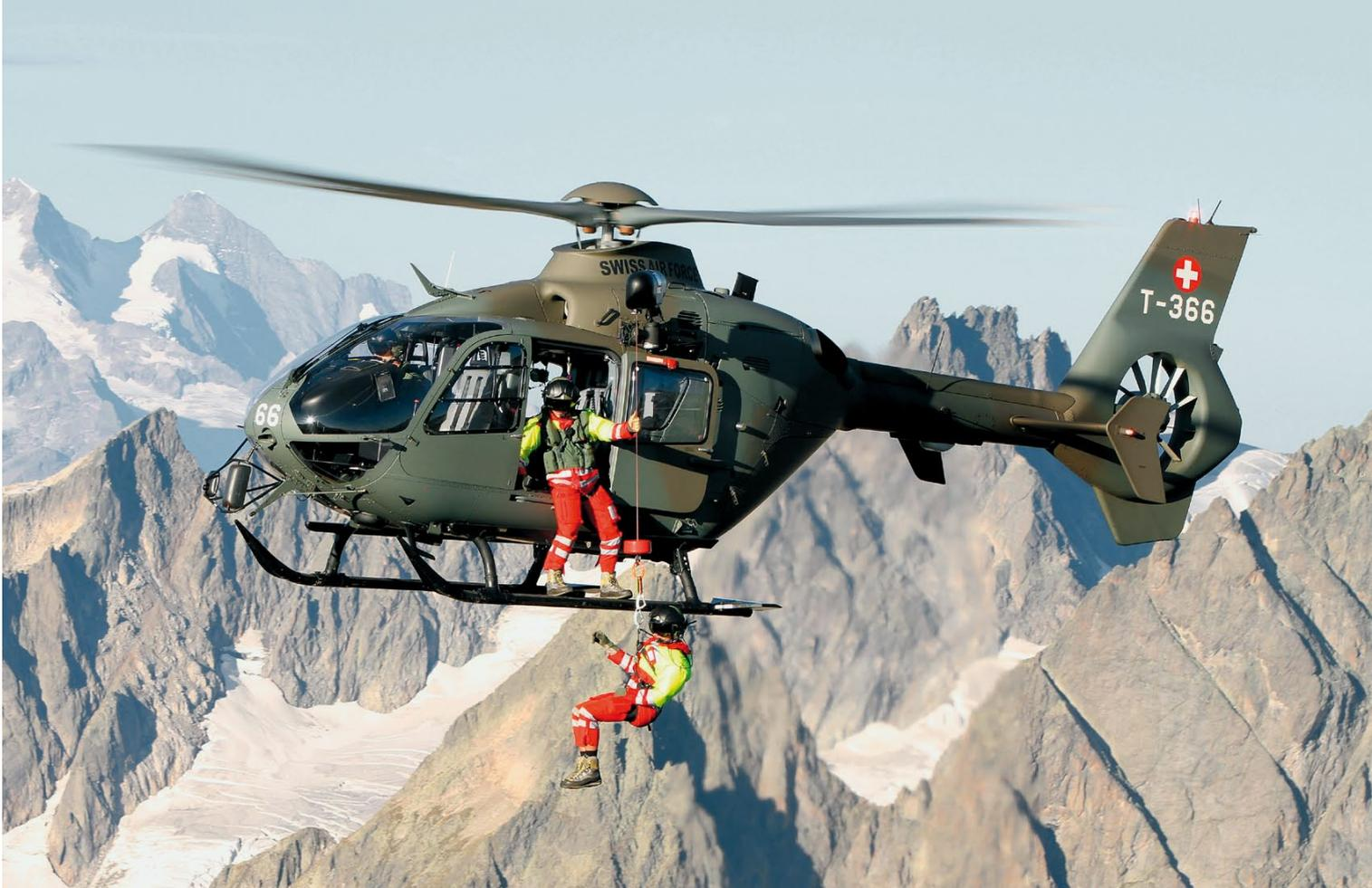
Der EC635 bewährt sich auch in den Alpen: Schwebeflug über dem Sustengebiet mit Windeneinsatz auf 2900 Metern Höhe bei ISA +10 Grad und Resttreibstoff für eine Flugstunde.
