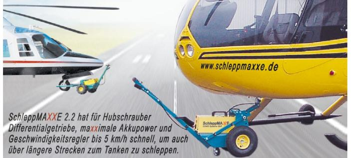
SchleppMAXXE 2.2 hat für Hubschrauber Differentialgetriebe, maximale Akkupower und Geschwindigkeitsregler bis 5 km/h schnell, um auch über längere Strecken zum Tanken zu schleppen.
