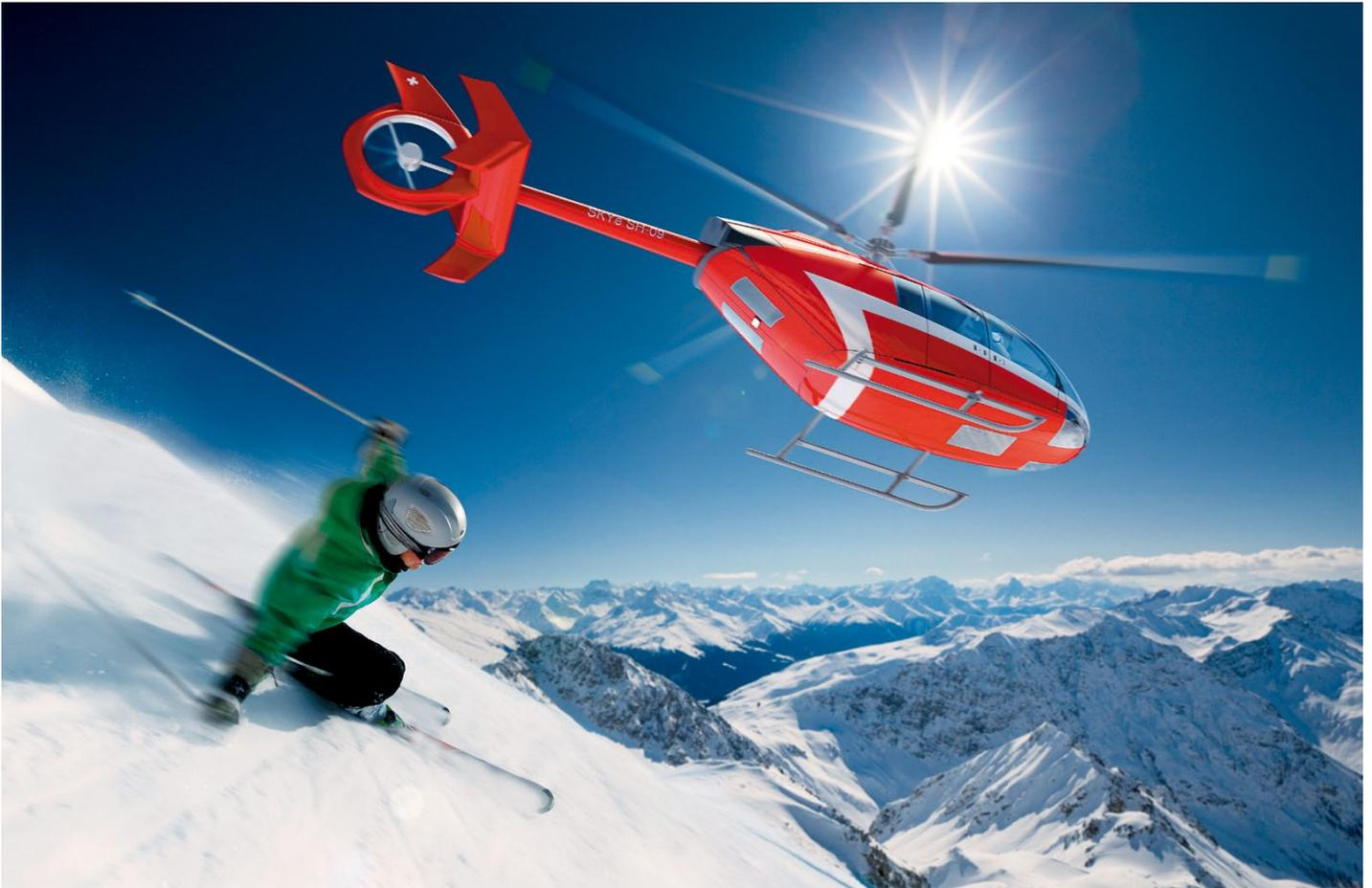
Ein leiser Top-Performer auch im Gebirge: Die Ingenieure von Marengo Swisshelicopter wollen überragende Hot-and-high-Leistungen erreichen. Selbst bei einer Temperatur von ISA +20 Grad und 2200 Kilogramm Startgewicht soll auf Matterhornhöhe (4474 Meter) Schweben für eine Windenrettung möglich sein.
