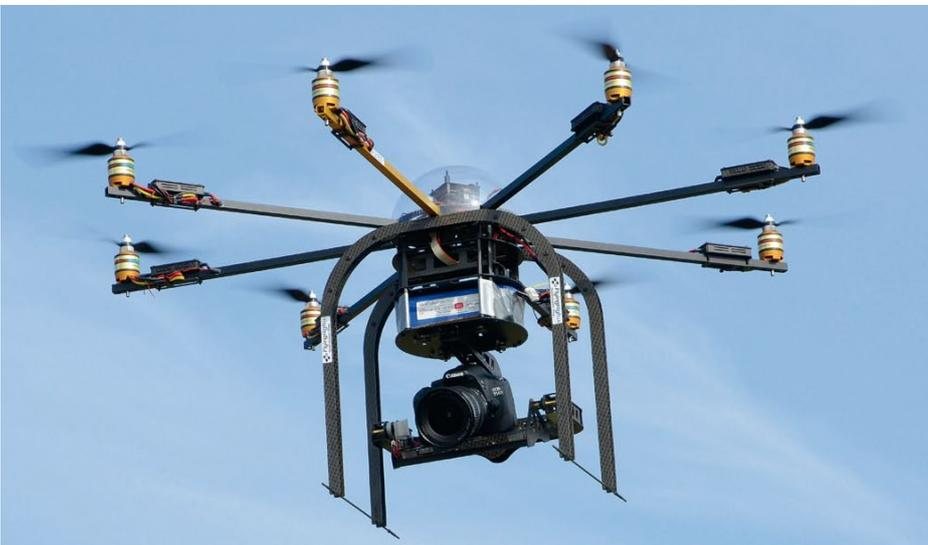
Der Oktocopter mit montierter Spiegelreflexkamera in Aktion.
