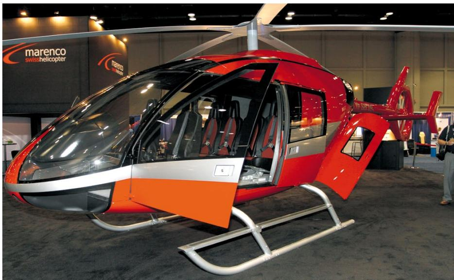
Der SKYe SH09 ist auf der HeliExpo 2011 in den USA auf ein sehr positives Echo gestossen. Ein durchgehend flacher Boden und grosse Hecktüren sollen maximale Flexibilität garantieren. Der Heli in der 2,5-Tonnen-Klasse kann mit bis zu acht Sitzplätzen ausgerüstet werden.
