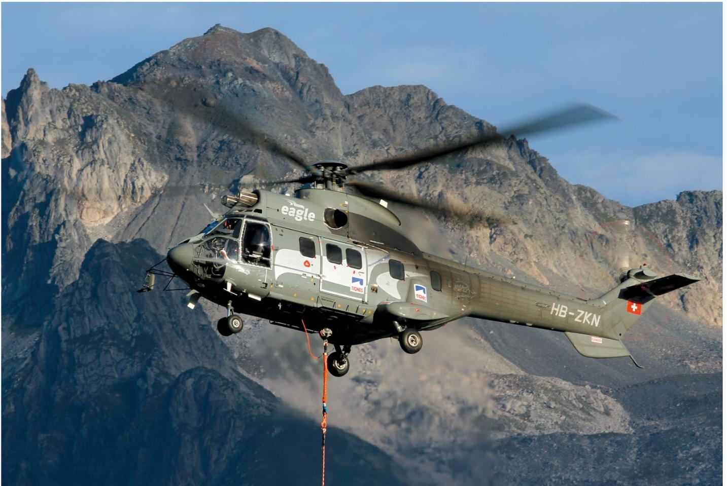
Seit April 2011 fliegt Justin Mattia auf dem 2009 gebauten AS332C1 Super Puma HB-ZKN von Eagle Helicopter. Dank Schnelligkeit, Zuverlässigkeit, grosser Kabine und eines Hebevermögens von bis zu 4,5 Tonnen ist das für Justin Mattia der ideale Heli für die Arbeitsfliegerei im Schwerlastbereich.
