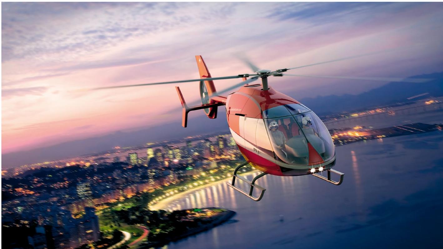
Ein lagerloses Fünfblatt-Rotorsystem, kombiniert mit einer geräumigen, vollständig aus Karbon gefertigten Zelle für höchste Flexibilität und einer verbrauchsgünstigen, FADEC-gesteuerten Turbine – mit diesen Design-Merkmalen soll der SKYe SH09 im Wettbewerb mit den etablierten Heliherstellern punkten.
