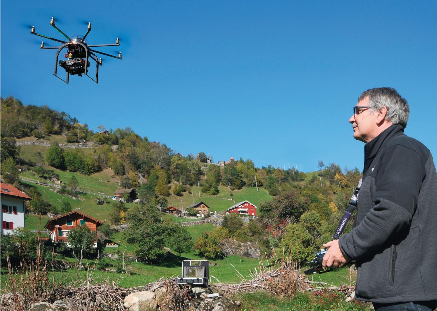
Der modellflugbegeisterte Urner Fotograf Raini Sicher steuert seinen Oktocopter, der eine bis zu vier Kilogramm schwere Kamera heben kann. Im Koffer befindet sich die aus einem Laptop bestehende Bodenstation.
