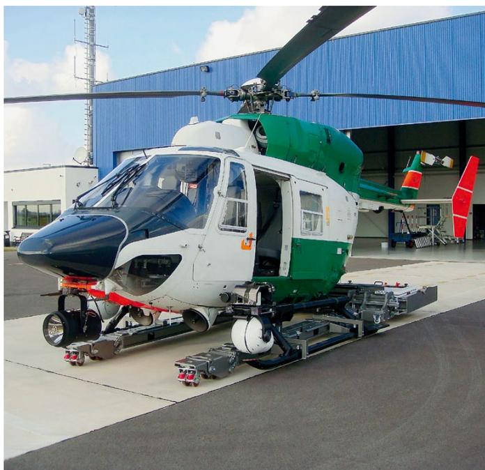
Selbst wenn umfangreiche Zusatzausrüstung montiert ist, nimmt der Mototok HELIMO Kufenhubschrauber problemlos auf, um sie sicher zu hangarieren.
