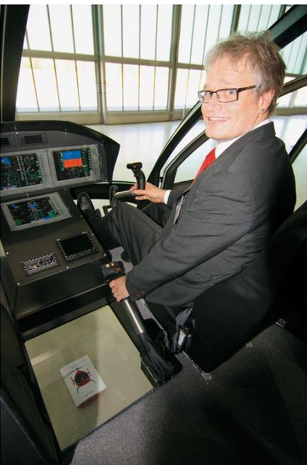
Martin Stucki im Cockpit des SH09. Die verglaste Bodenplatte ermöglicht dem Piloten eine bequeme Sicht auf Aussenlasten.
