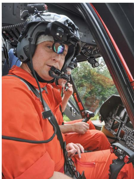
Das Head Mounted Display, in der Form eines Monokels, projiziert dem Piloten die wichtigsten Flugparameter direkt vors Auge.
