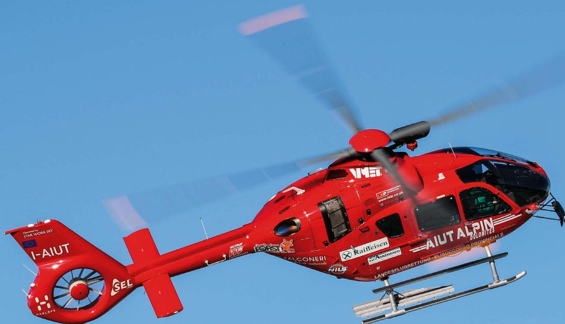
Besonders im Gebirge zeigt der EC135T3 seine neue Stärke. Bei maximalem Startgewicht von 2980 Kilogramm und ISA+20 soll Schweben ausserhalb des Bodeneffektes noch bis 2134 Meter Höhe möglich sein.
