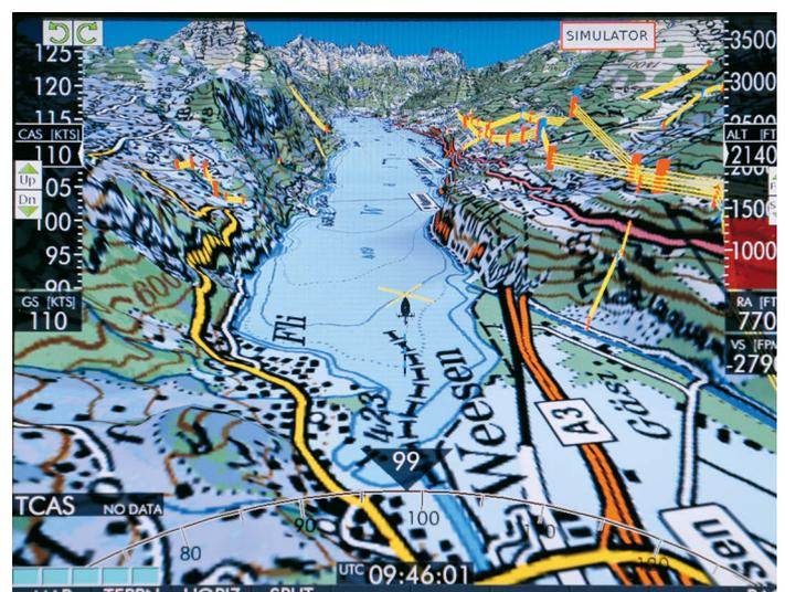
Split-Screen mit aufgeschaltetem TAWS und TCAS: Über Niederurnen nähert sich ein Flugzeug auf Gegenkurs (links). MT Terrain mit klar erkennbaren Hindernissen im «Birds Eye View». Der Pilot sieht seinen Heli (hier über dem See) in einer Aussenansicht.
