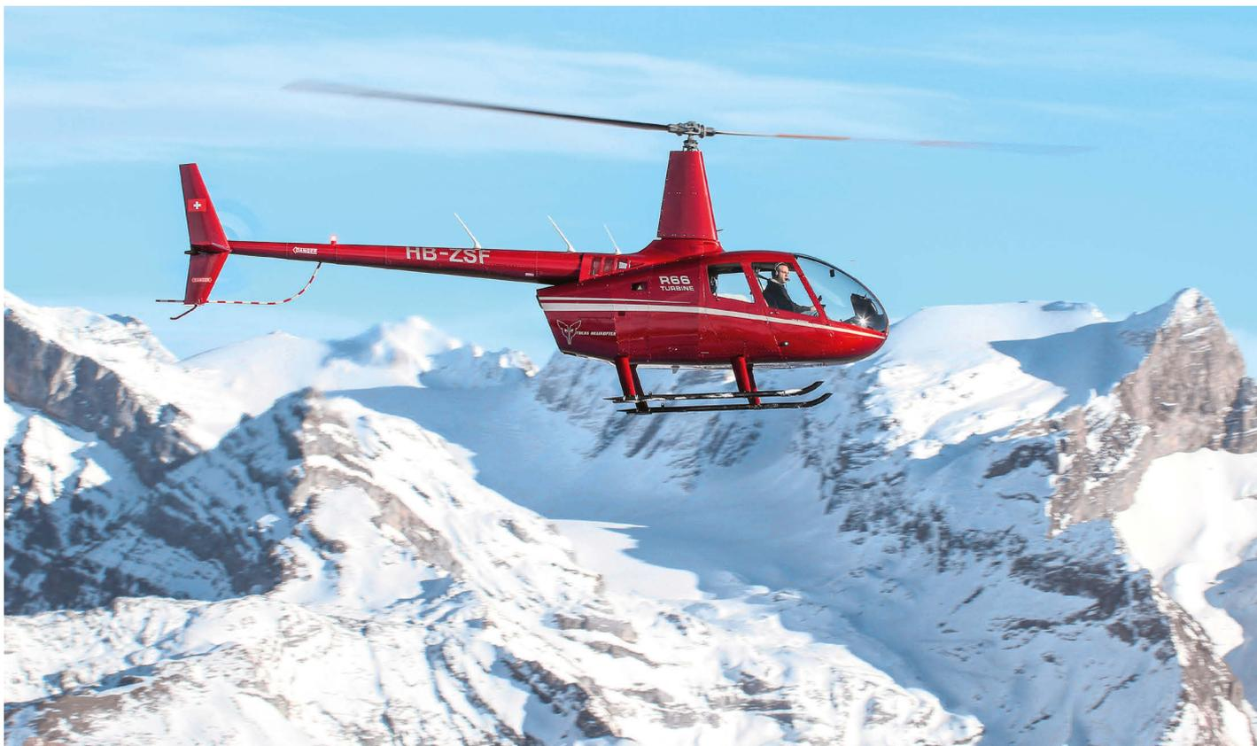
Ein guter Alpinist, hier mit dem Glärnisch im Hintergrund: Robinson verspricht bei maximalem Startgewicht eine OGE-Schwebeflughöhe von über 10'000 Fuss (3048 Meter). Die ersten Erfahrungen von Fuchs Helikopter bestätigen die Werksangaben.
