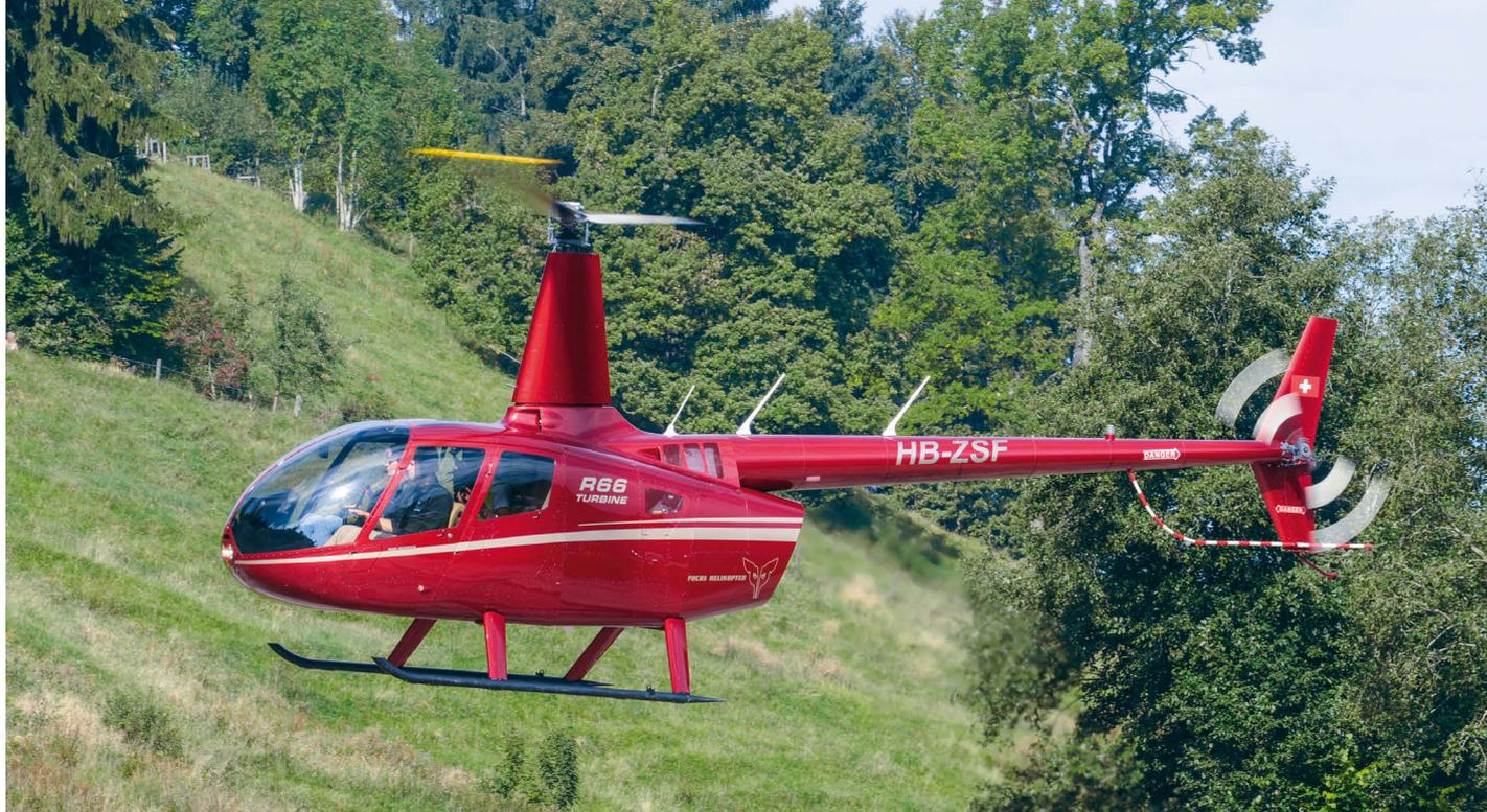
Von aussen sieht der R66 Turbine einem R44 täuschend ähnlich, obwohl die Kabine leicht länger und breiter ist. Unterscheidungsmerkmale sind zum Beispiel die kleinen Öffnungen an der Wurzel des Rotormasts.
