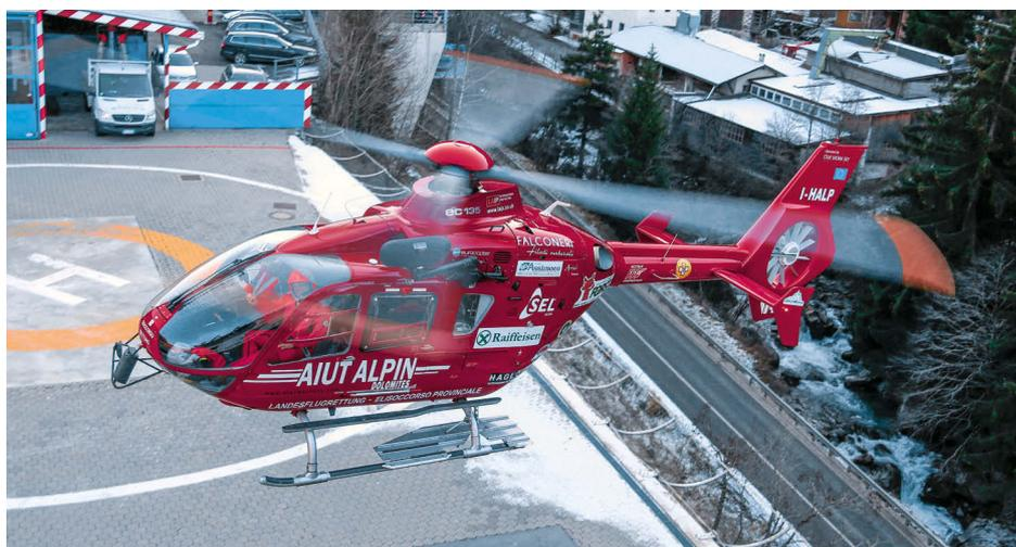
Der Vorgänger des EC135T3 bei Aiut Alpin Dolomites, der klassische EC135T2i mit den horizontalen Flossen am Stabilizer-Flügel, die beim neuen Heli fehlen.
