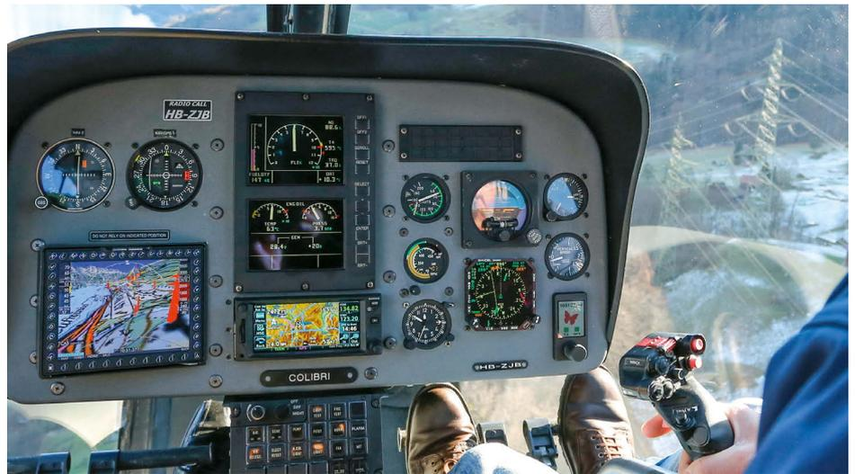
Ein starkes Safety-Element: Die laufend aktualisierte Hindernisdatenbank zeigt Hindernisse wie Kabel und Masten in warnenden Farben: Der Mast rechts im Gelände ist auf dem Display am rechten Rand in rot zu sehen.
