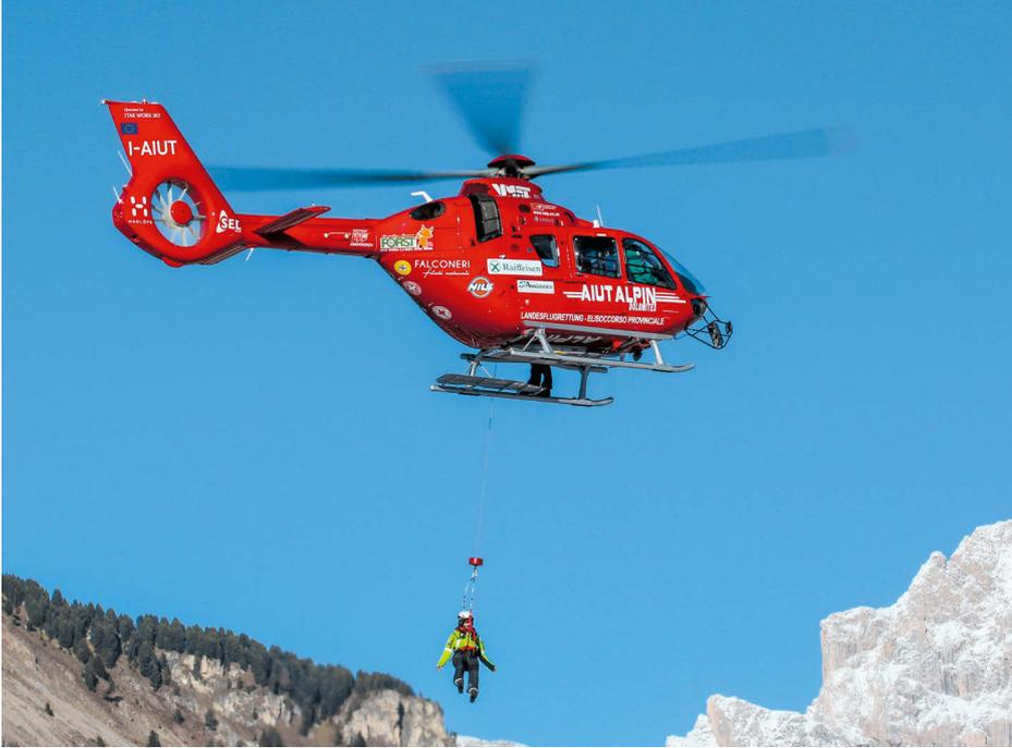
Leistungsfähiger ist auch die neue Rettungswinde. Am bis auf 90 Meter ausfahrbaren Windenseil können neu bis zu 272 Kilogramm schwere Lasten eingehängt werden, 37 Kilogramm mehr als bei der alten Winde.
