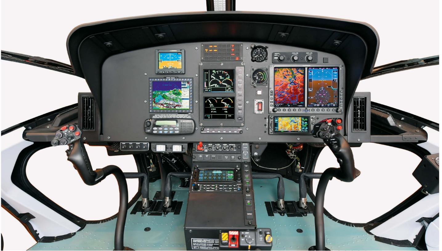
Top ausgerüstetes AS350B3e-Cockpit, rechts mit den zwei grossen Bildschirmen des G500H, darunter das GTN650 (als COM 1) und einem zweiten GTN650 in der Mittelkonsole als COM 2. Unten am Instrumentenbrett ist das Bedienpanel des digitalen HeliSAS-Autopiloten verbaut.
