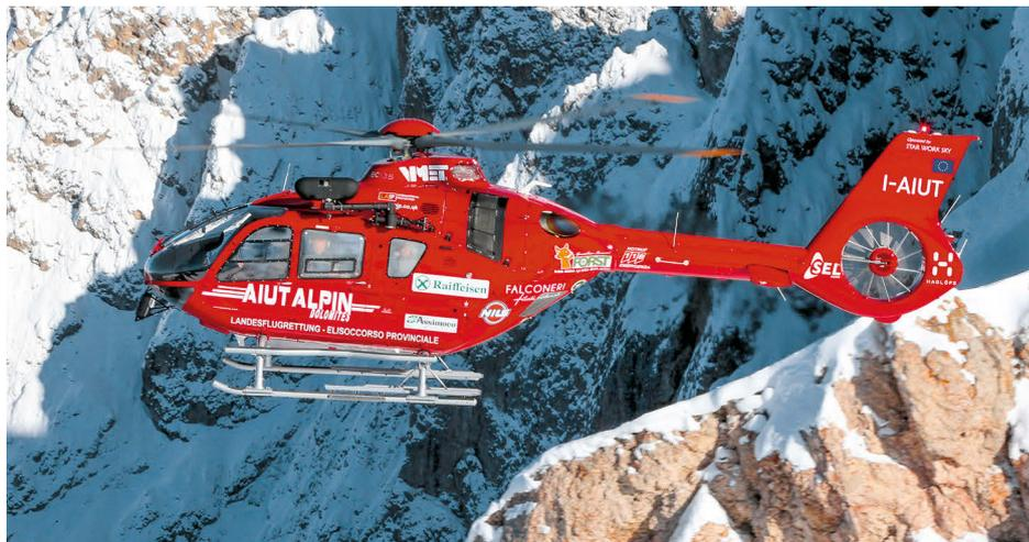
Optimiert sind auch die Leistungen für den Fall, dass eine Turbine ausfällt (OEI-Performance). Auf Meereshöhe und bei ISA-Standardtemperatur verspricht der Hersteller selbst bei maximalem Startgewicht eine Steigrate von zwei Metern pro Sekunde mit nur einer Turbine.
