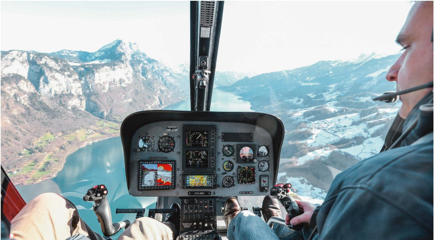
Das MT VisionAir X Heli (links im Instrumentenpanel) liefert dem Piloten – hier im EC120B Colibri von Swiss Skyways – bei jedem Wetter die notwendigen Informationen für die Wahl eines sicheren Flugweges.
